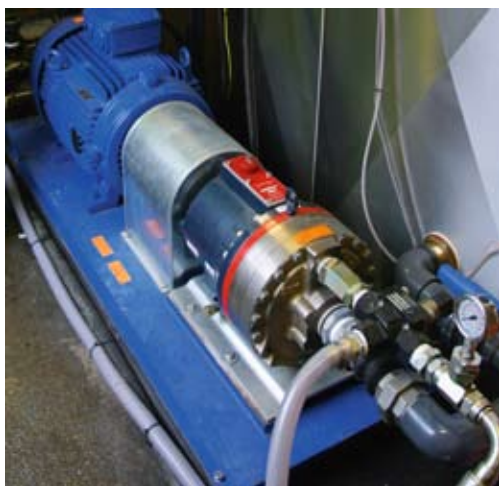
Das System basiert auf einer energie-effizienten, dichtungslosen Hydra-Cell Pumpe, die Splittpartikel bewältigen und rückgewonnenes Wasser bei Drücken bis zu 70 bar fördern kann.
